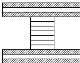
**CAISSON = 2 panneaux KLH + 1 Nervure**
