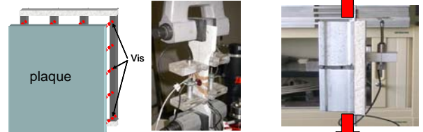
Constituants d'une cloison Loi du comportement du parement Raideur du vissage
