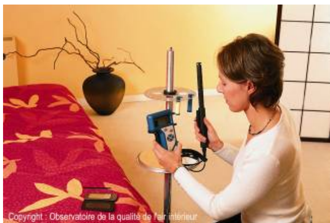
Recueil des composés organiques volatils, aldéhydes, température, humidité, dioxyde de carbone dans un logement.
