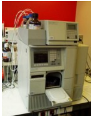
Système de chromatographie en phase liquide (HPLC) pour l'analyse du formaldéhyde et d'autres composés carbonyles
