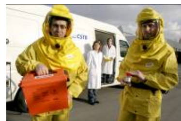
Unité mobile autonome pour collecter et analyser les légionelles aéroportées
