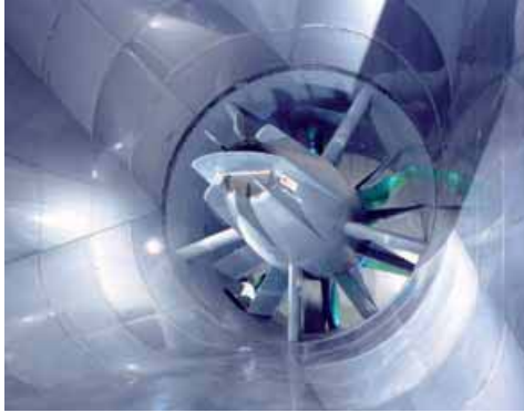
Soufflerie Jules Verne : Programmes expérimentaux sur le comportement en vraie grandeur des bâtiments et des éléments de construction dans n'importe quelle condition climatique
