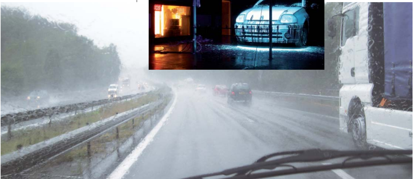
Simulation et visualisation UV d'essuyage en veine haute vitesse (jusqu'à 250 km/h)
