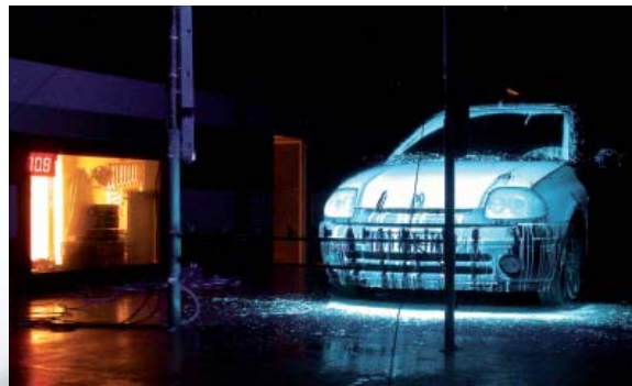
Simulation et visualisation UV d'essuyage en veine haute vitesse (jusqu'à 250 km/h)
