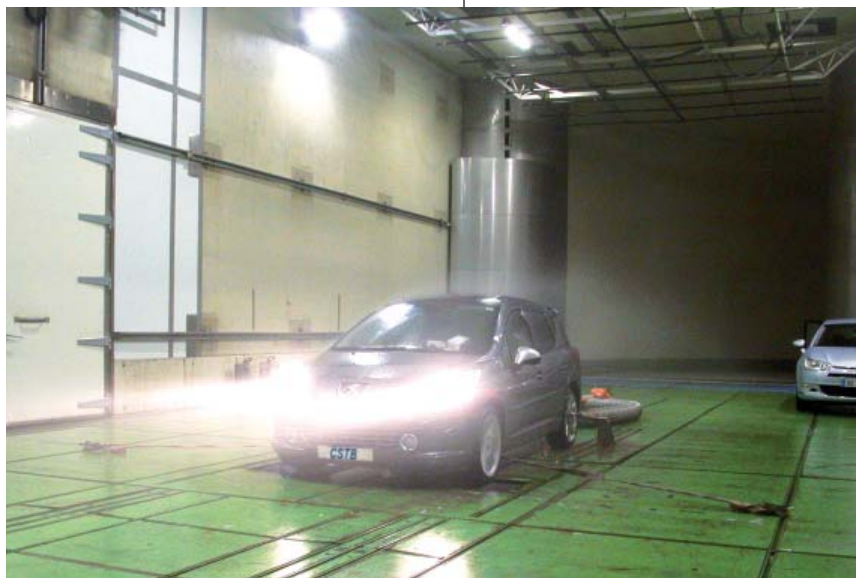
Simulation de pluie dynamique sur banc à rouleaux
