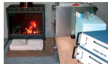
Analyse des teneurs en CO et CO 2 dans les fumées par spectrométrie infrarouge
