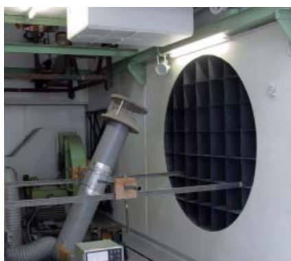
Qualification des performances aérauliques d'un terminal de ventilation naturelle avec vent latéral (Aérodynamique Eiffel - Groupe CSTB)
