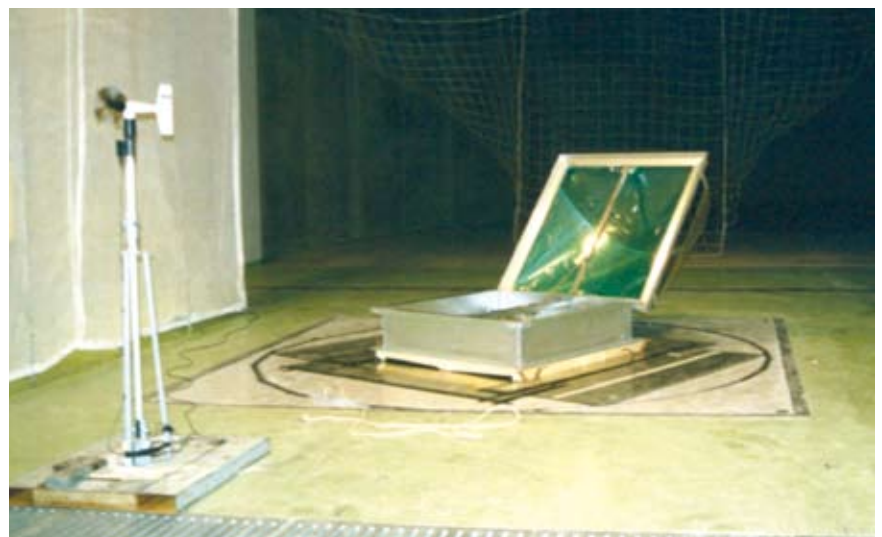
Qualification aéraluque d'un exutoire dans la soufflerie climatique Jules Verne
