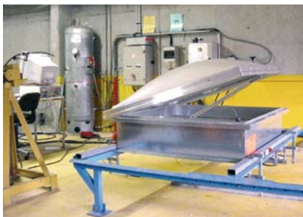
Essais de fiabilité (ouverture/fermeture) sur exutoires de désenfumage
