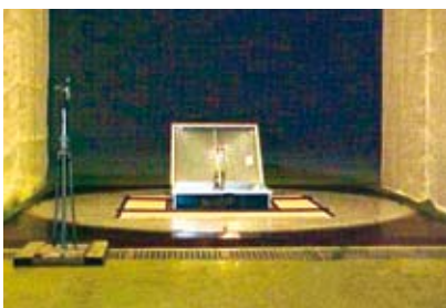
Essai d'ouverture en soufflerie climatique Jules Verne
