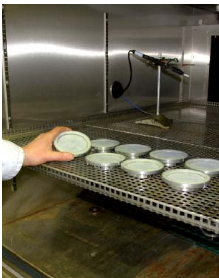
Essai de détermination de la proportion de transmission de vapeur d'eau sur un écran de sous-toiture
