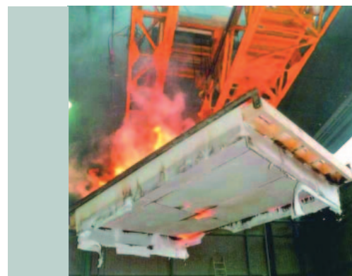
La thermographie, un outil de recherche qui vise l'amélioration des produits de construction face au feu. Ici, différents champs thermiques identifiables sur une porte soumise à un essai feu.
