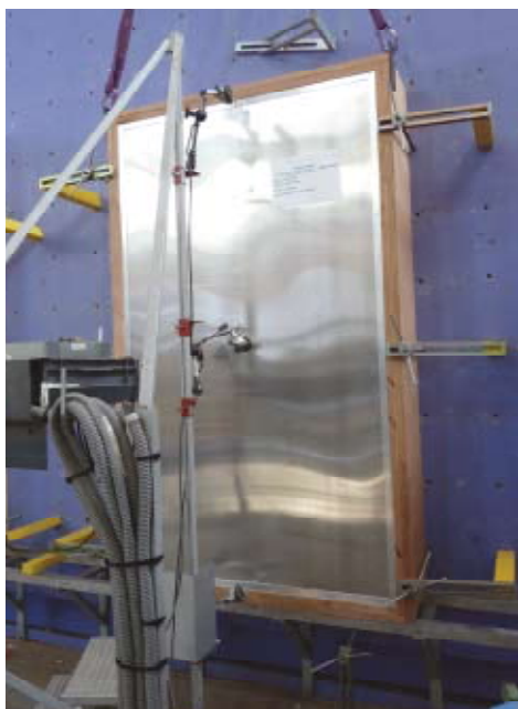
⤵ Capteur solaire en cours de test de résistance au vent
