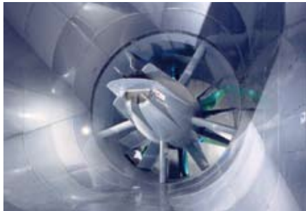
Soufflerie Jules Verne : Programmes expérimentaux sur le comportement en vraie grandeur des bâtiments et des éléments de construction dans n'importe quelle condition climatique
