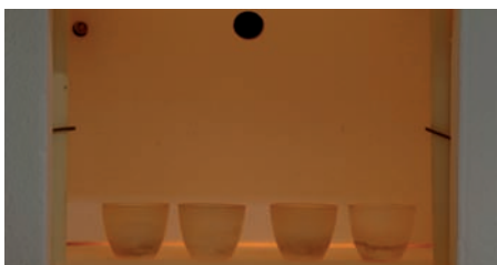
☒ Le test du taux de cendre permet de connaître la composition exacte
