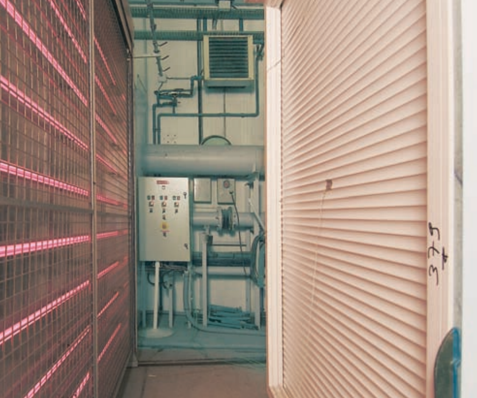
Banc d'ensoleillement : les tabliers sont soumis durant 6 heures à des températures de 50° pour les tabliers blancs et clairs et 70° pour les tabliers foncés, puis subissent des chocs thermiques.
