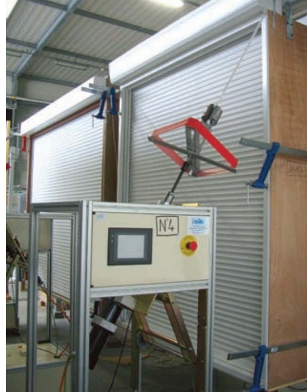
Banc d'endurance mécanique : les volets sont soumis à des cycles de repliement-déplioement (7 000, 10 000 ou 14 000) équivalents à plusieurs années d'utilisation.
