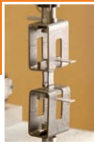
Essai de traction sur profilé aluminium RPT
