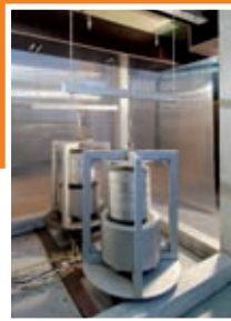
Essai de vieillissement (10 6 cycles) sur profilé aluminium RPT
