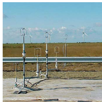
Influence d'une barrière sur les vents traversiers
