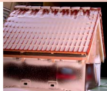
Tests d'étanchéité d'une toiture au vent de neige
