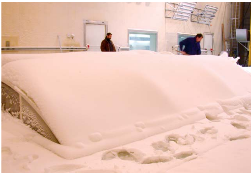
Charge de neige d'une structure à l'échelle 1
