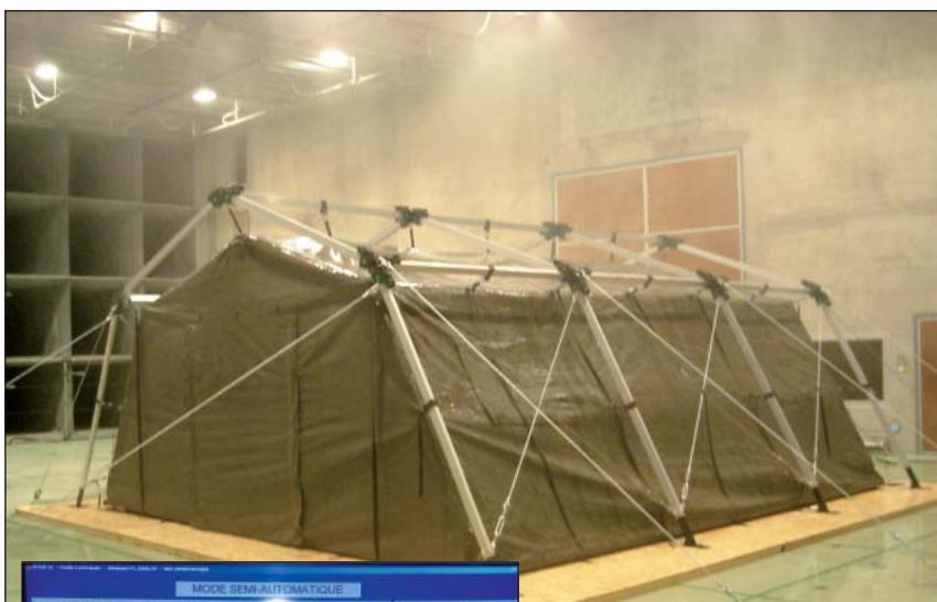
Test en condition de pluie battante d'une tente d'urgence dans la veine environnement © Brescianigroup
