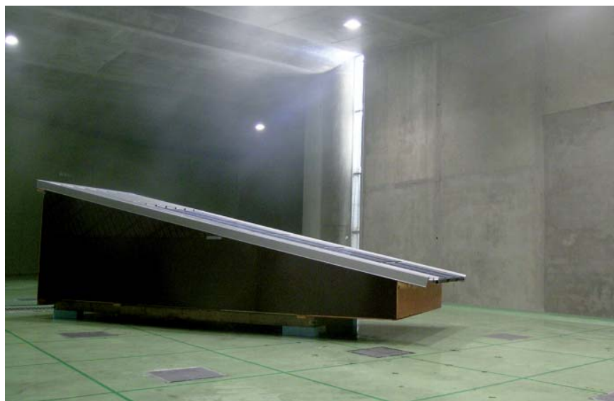
Comportement à la pluie d'une couverture munie de panneaux solaires photovoltaïques.
