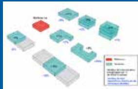
Figure 2 : Influence des facteurs morphologiques sur la performance énergétique moyenne annuelle de MI du parc français construits entre 1945 et 1974, période de construction la plus mauvaise du point de vue efficacité énergétique.
