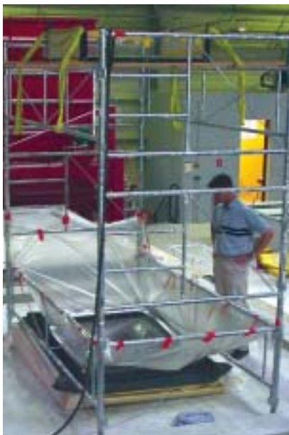
Le banc d'essai permet de tester les fenêtres, les vérandas, les toitures industrielles...
